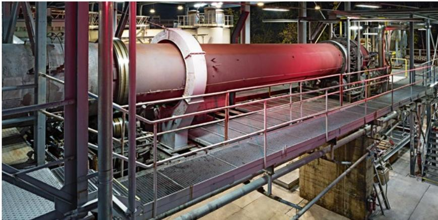
Bild 4 Der direkt befeuerte Drehrohrfurnen GDO des Unternehmens (© IBU-tec)
